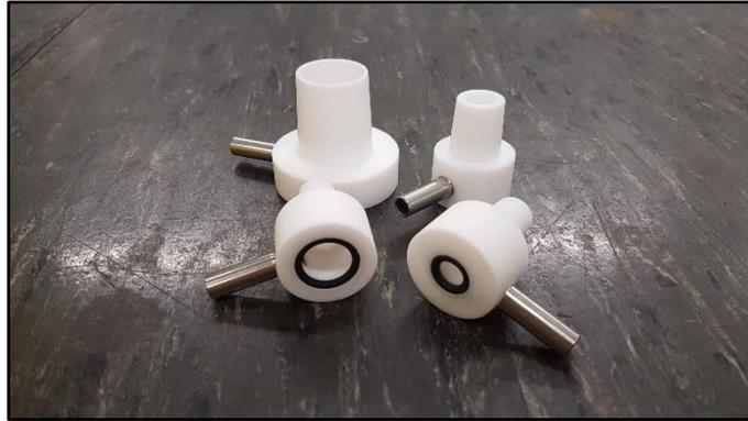
Die Teflonkonen werden für das Vakuumfiltern von Flüssigkeiten mit Feststoffen gebraucht. Das Auffangbehälter mit Glasnormschliff wird an dem Konus montiert und die Glassfritte oder Nutsche auf dem O-Ring platziert. Durch evakuieren des Rohrs kann man das passieren der Flüssigkeit durch die Glasfritte oder Nutsche beschleunigen.
