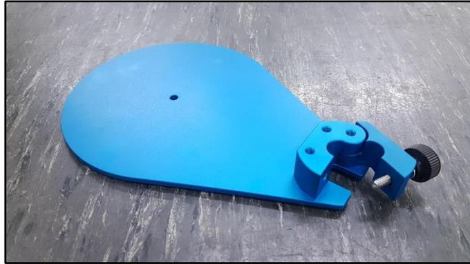
Für Dewar in Abzugshauben können diese Halter eingesetzt werden. Die Halter werden an Standard  $\varnothing 13$  mm rostfrei Stangen montiert und können seitlich eingefädelt werden. Die Dewar Halter bestehen aus Aluminium und sind Eloxiert.
