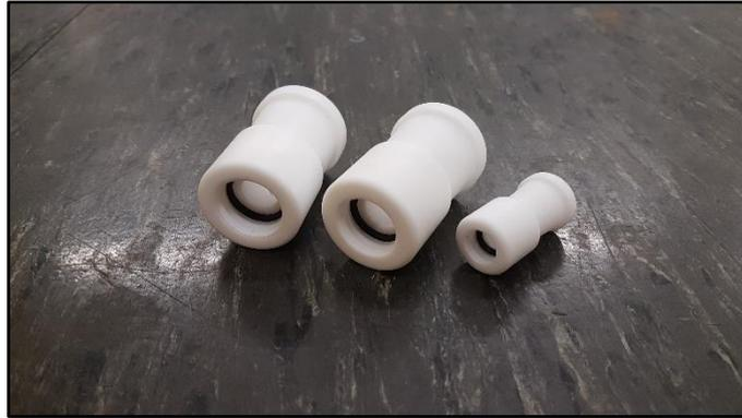
Anschlusskonusen werden als Adapter für das evakuieren von Gewindeflaschen am Rotationsverdampfer gebraucht. Die Anschlusskonusen bestehen aus PTFE mit einem Viton O-Ring.
